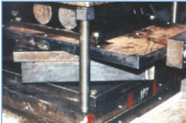
45도 셋팅에 의한 전방향 성능시험 전경
